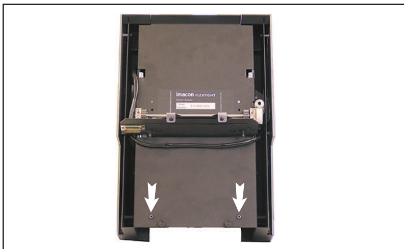
Abbildung 2: Lage der Transportsicherungsschrauben an der Rückwand der Zuführung
