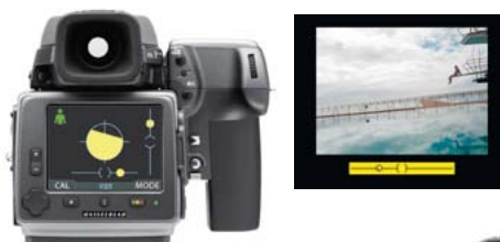
La livella elettronica è visualizzata sia nel mirino che sull'LCD posteriore.
